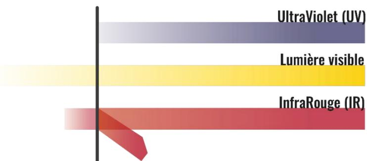
Les panneaux Danpalon® perle infrarouge sont des panneaux Danpalon® avec une protection infrarouge **teintée dans la masse**. Cette protection est un traitement spécifique pour **limiter considérablement les apports solaires thermiques** sans dégrader la transmission lumineuse, contribuant ainsi directement au confort d'été et à l'efficacité bioclimatique.
